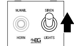
**NOTA:** Si tiene luces conectadas, cada vez que active SIREN el sistema de luces se encenderá automáticamente.
