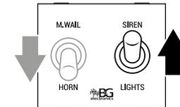
2. Sin soltar HORN, suba SIREN. HORN dejará de sonar, indicando que entró al modo de configuración del tono SIREN.
