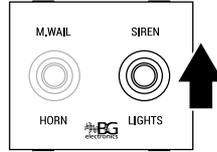
1. Para apagar las luces, baje el switch a su posición central.
