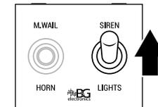
**NOTA:** Si tiene luces conectadas, cada vez que active SIREN el sistema de luces se encenderá automáticamente.
