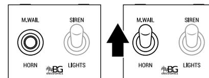
3. Presione y suelte M.WAIL para cambiar entre los dos modos.
