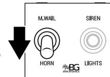
**NOTA:** La reproducción de HORN se antepone a todas las funciones. Al soltar HORN el equipo retornará a la función que se estaba ejecutando anteriormente.
